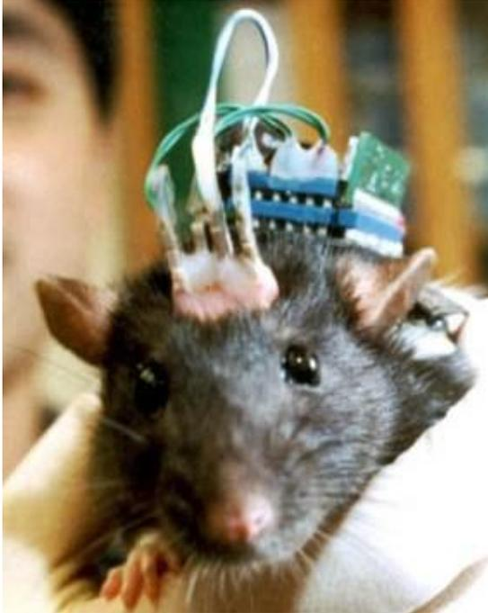
Topo a guida remota, con elettrodi impiantati nella corteccia cerebrale sviluppato nel 2002 da Sanjiv Talwar e John Chapin (State Univ. New York). Il topo indossa un piccolo dispositivo elettronico con un radoricevitore e uno stimolatore elettrico. Gli stimoli elettrici provocano azioni guidate del topo e sensazioni di piacere e appagamento.
